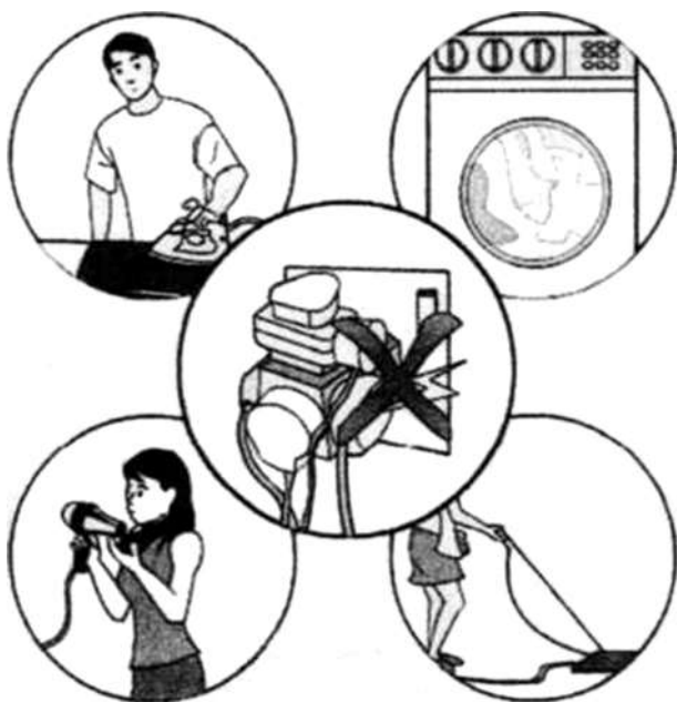
Hình 2.10. Không sử dụng nhiều thiết bị điện trên một ổ cắm
