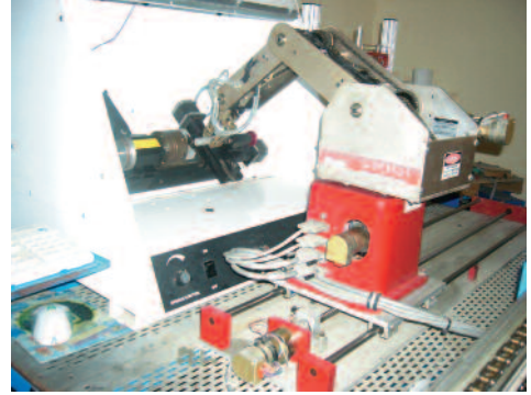
Hình 19.2. Ứng dụng rôbốt trong tháo lắp phôi trên máy công cụ
